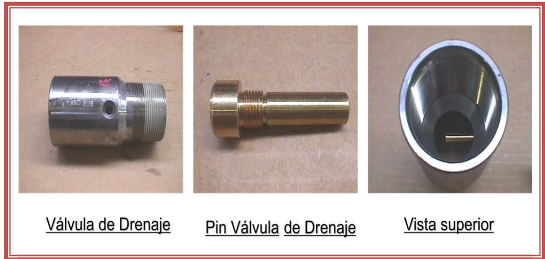
FIGURA 36. VÁLVULA DE DRENAJE. 40
