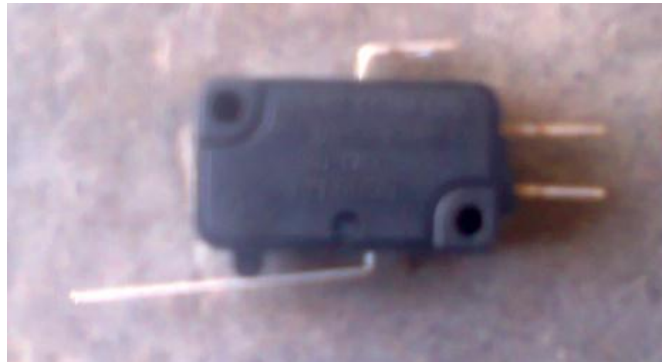
Figura 27. Sensor fin de carrera.
