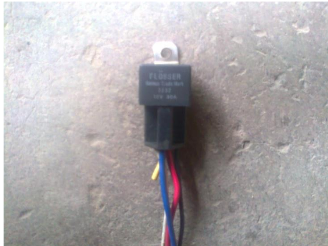
Figura 48. Uno de los relés para accionamiento de Motores DC.
