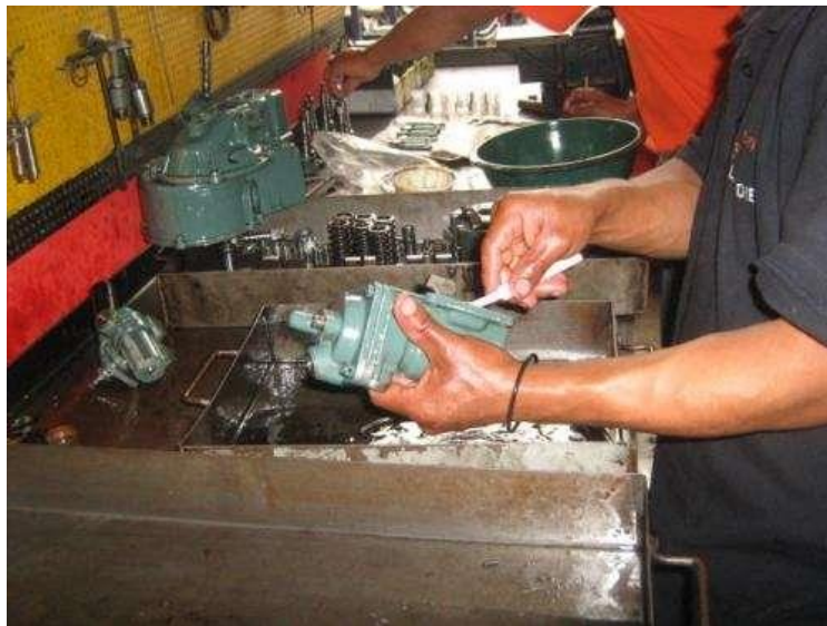
Gráfica 48 Lavado de bombas de inyección con mezcla de gasoil sin EPPs.
