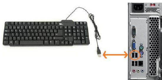
Figura 6.36. Conexión del teclado. Elaborado por: Investigador
