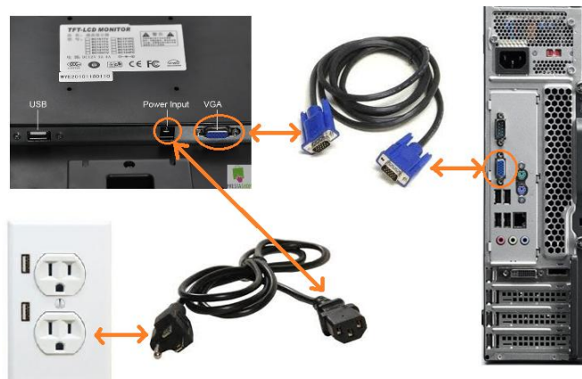
Figura 6.38. Conexión de la pantalla. Elaborado por: Investigador
