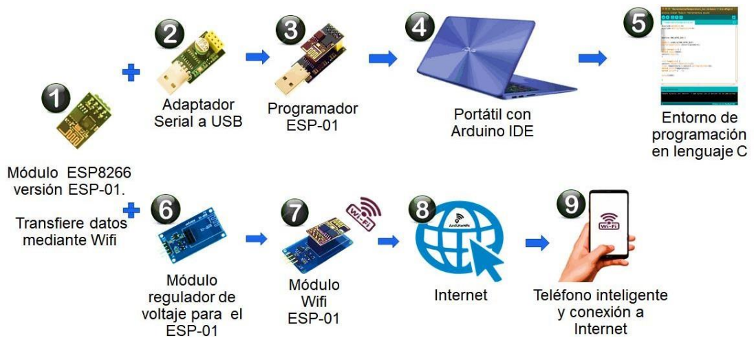
Figura 19. Elementos del Módulo Wi-Fi .
