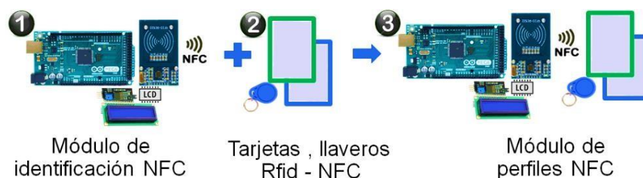
Figura 17. Elementos de una identificación NFC mediante Lcd .
