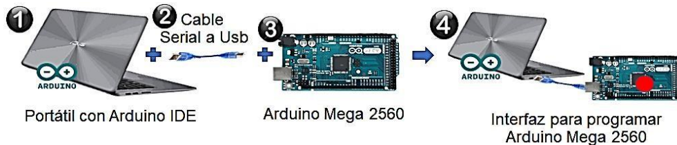
Figura 13. Recursos para interactuar con el Arduino Mega 2560 .
