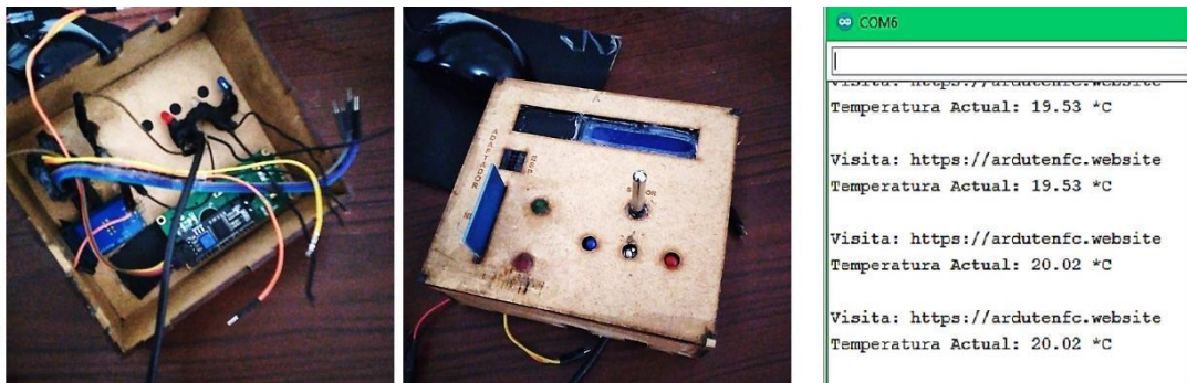
Figura 26. Lectura del sensor de temperatura mediante el puerto serial.
