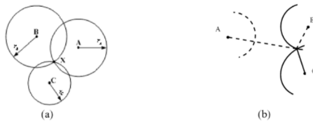
Figura 2. Boceto de un TOA (a) y TDOA (b) (Shen & Huang, 2011).
