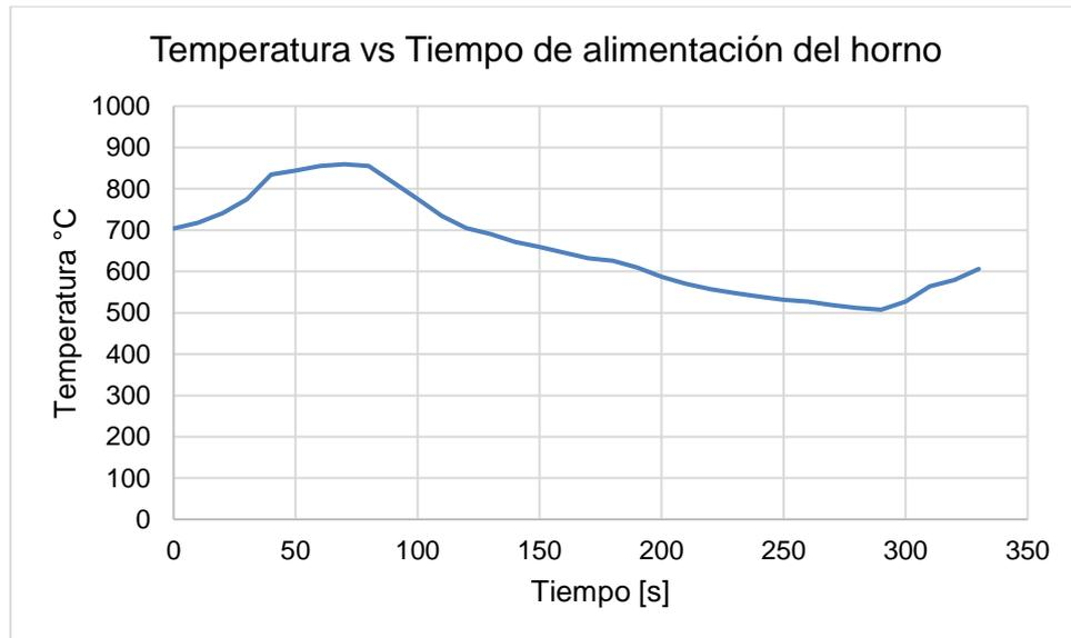
**Figura 35.** Periodo de alimentación del horno con BCA en un intervalo de 330 [s]
