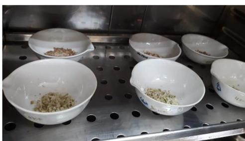
Colocación de las cápsulas en la estufa
