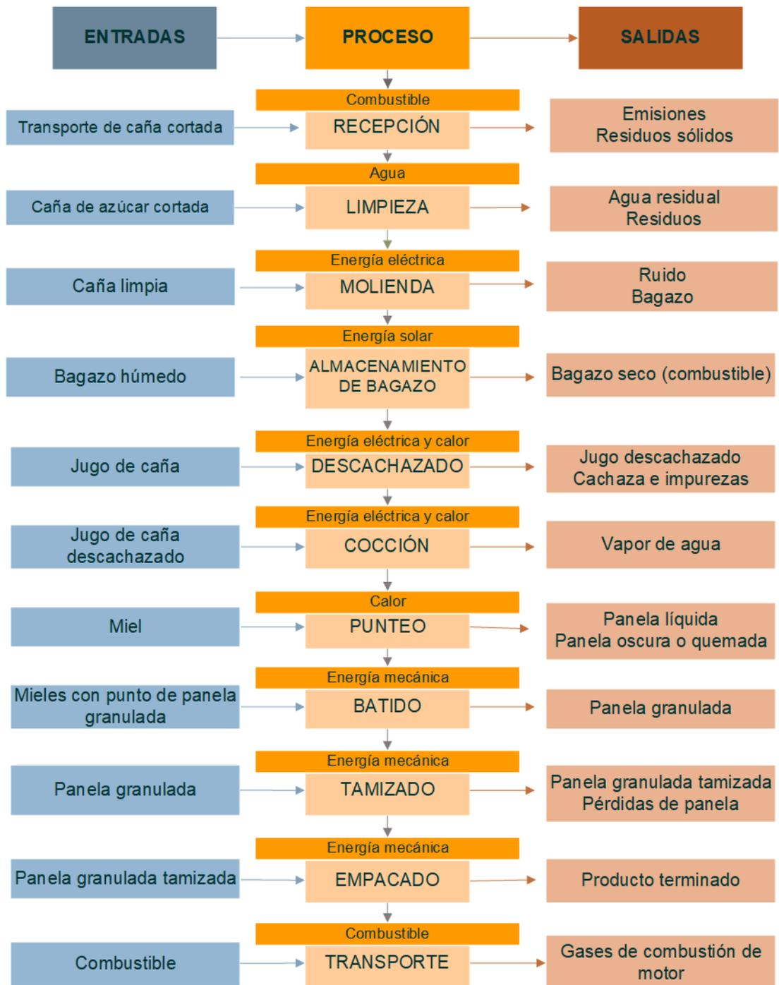
**Figura 45.** Ecobalance del proceso de producción de panela granulada
