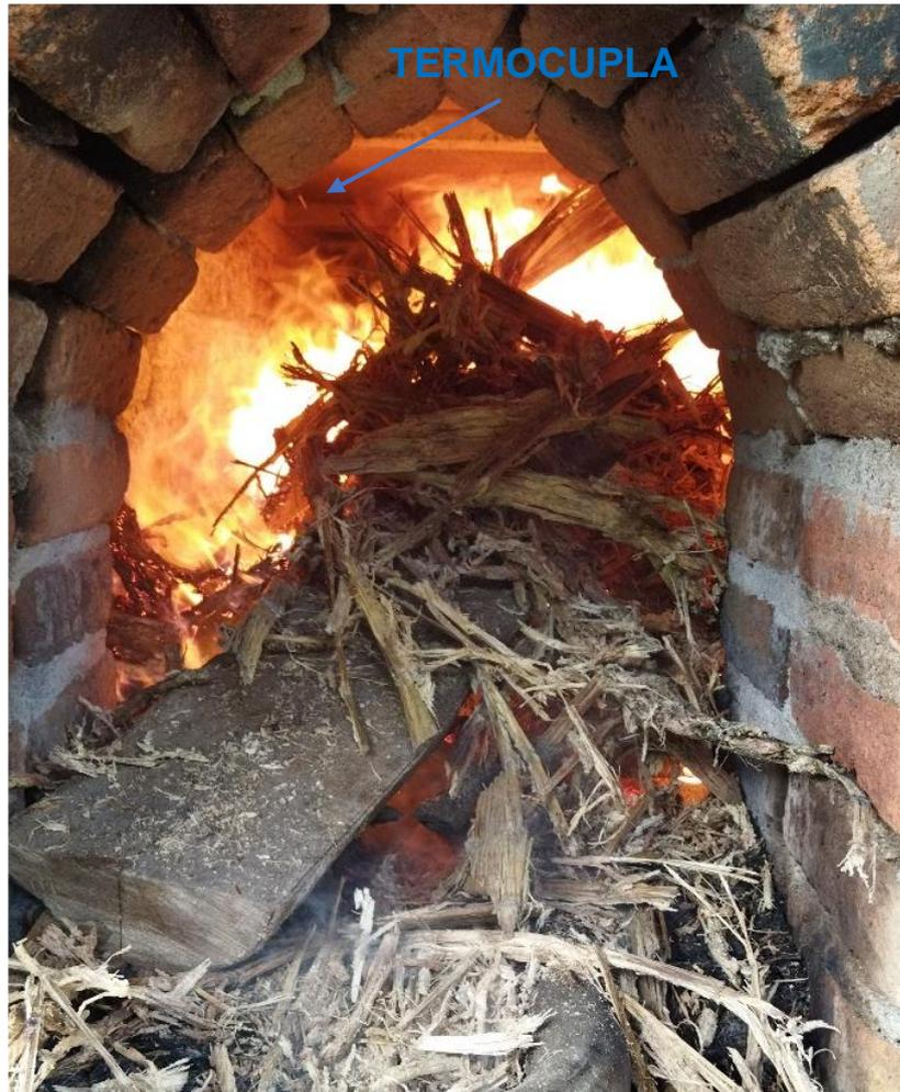
**Figura 3.** Vista de la ubicación de la termocupla desde el interior del horno
