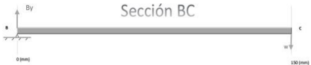
Figura 13. Análisis estático eslabón BC
