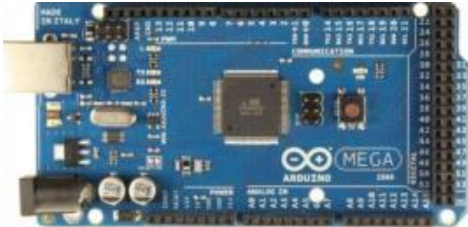
Figura 8. Placa de Desarrollo Arduino Mega 2560. (Akbar iskandar, 2017)
