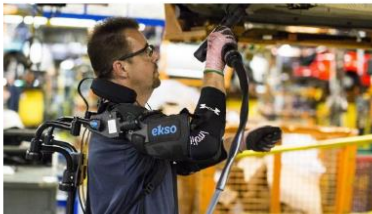
Figura 3. Exoesqueleto EksoVest. (Alexis Gonzalo, Leopoldo Javier, 2018)
