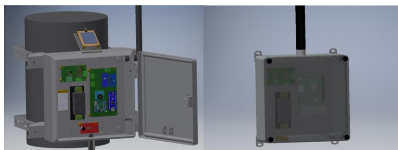
Figura 5 Diseño 3D del Sistema de Monitoreo Acustico IoT, nodo (izquierda) y gateway (derecha).
