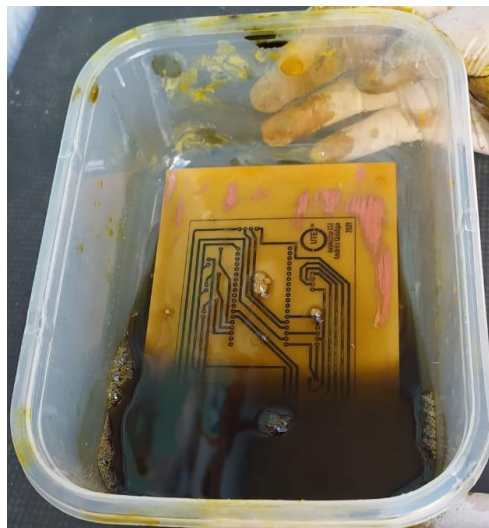
Figura 33 Baquelita sumergida en Cloruro Férrico con una superficie casi libre de cobre a excepción de las pistas cubiertas con tinta.
