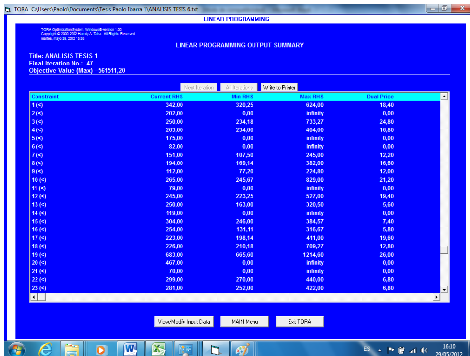
Figura 71. Pantalla 6 con resultados obtenidos en corrida de programa de Optimización lineal al incrementar volumen de inyección a 23818 barriles en programa “TORA”.
