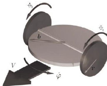
Figura 1. Variables involucradas en el movimiento del robot (Collazo, Gorrosieta, Pedraza, Villaseñor, & Romero, 2009).
