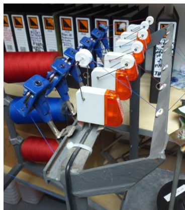
Figura 28. Sistema de alimentación de hilos
