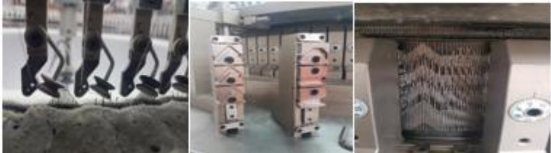
Figura 9. Guía Hilos, Tapas con levas y Agujas de una circular
