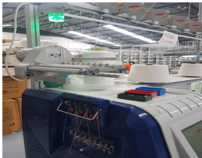
Figura 5. Motor para distribución de hilo (Textiles Cotopaxi, 2019).
