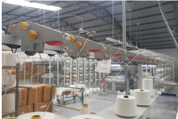
Figura 6. Disparo de aviso de falla de hilo (Textiles Cotopaxi, 2019).
