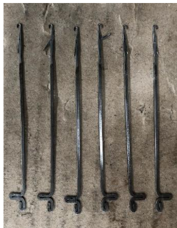
Figura 19. 6 agujas con lengüetas de talón bajo
