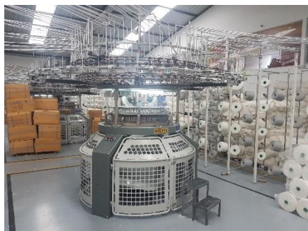
Figura 8. Circular Biotex con 102 tapas
