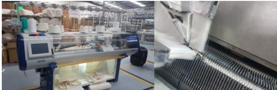
Figura 3. Máquina QL-52C, Ingreso de hilo a la rectilínea (Textiles Cotopaxi, 2019).
