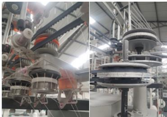
Figura 10. Alimentadores Memmingers y Caracoles de tensión
