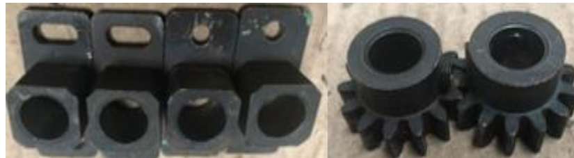
Figura 27. Bases de apoyo y catalinas de los rodillos de arrastre
