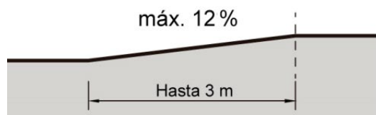
Figura 5. Pendientes longitudinales (INEN 2245, 2016-06)
