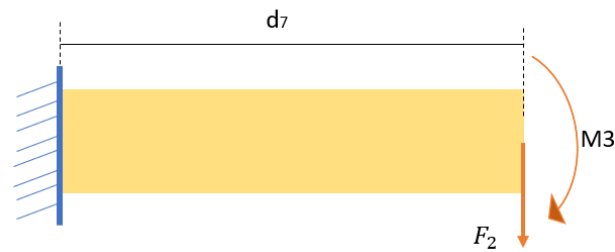
Figura 29. DCL de las fuerzas que actúan en el mecanismo vertical
