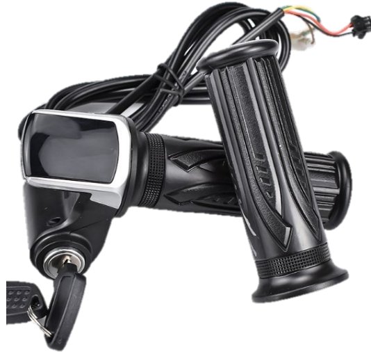
Figura 17. Acelerador con panel en forma de manillar
