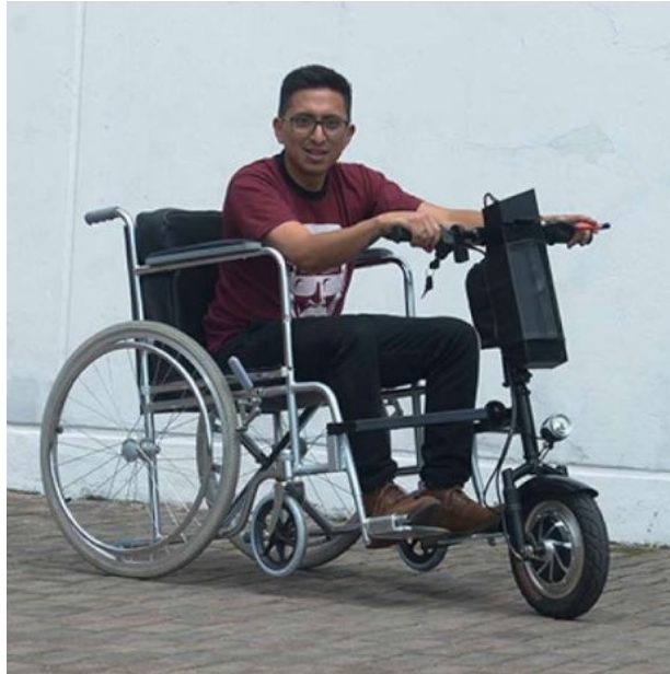
Figura 35. Prototipo físico anclado a la silla con el usuario
