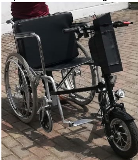
Figura 16. Posición de la batería en la parte frontal del dispositivo
