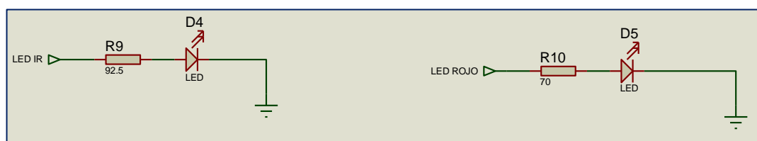
Figura 7. Subcircuito Medidor de Glucosa – Circuito Emisor
