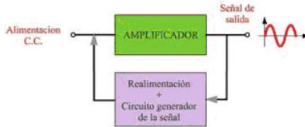
Figura 15. Diagrama de bloque de un Oscilador (Pablo Alcalde San Miguel, 2010)
