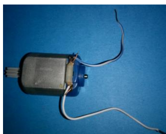
Figura 40. Motor DC utilizado para pruebas
