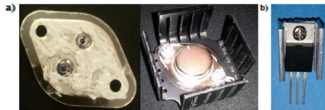
Figura 42. a) Montaje 2N3055 b) Montaje 2SC1061
