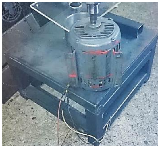
Figura 11. Mesa y motor del tribómetro "abrasivo pin disco".
