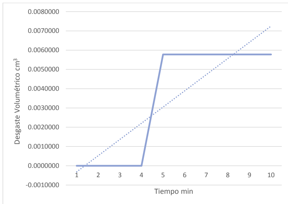
Figura 15. Desgaste vs Tiempo AISI 1045 a 40N con grasa y temperatura.
