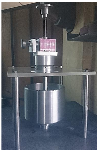
Figura 12. Placa plástica, recipiente y sistema Pin del tribómetro “abrasivo pin disco”.
