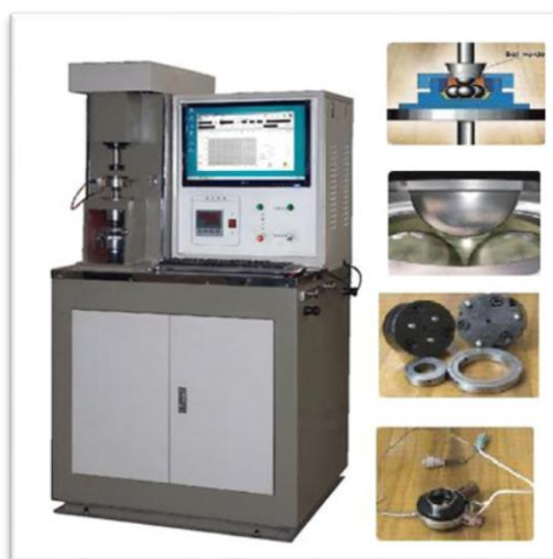
Figura 4. Tribómetro de control de revestimiento de goma. (Donnguan liyi test equioiment co., LTD, 2016)
