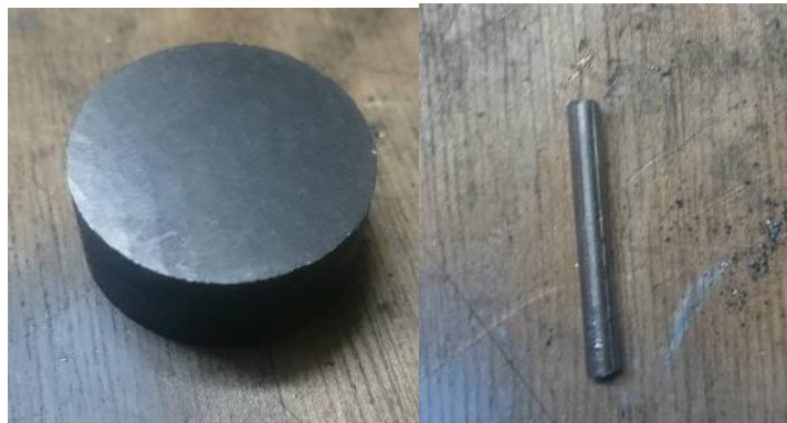
Figura 14. Pin y Probeta antes de las pruebas con el tribómetro.
