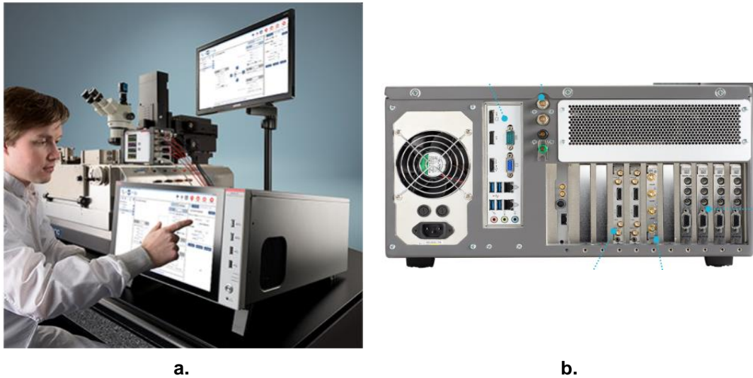
Figura 4. a. Trazador de curvas TEKTRONIX Keithley 4200A-SCS, b. Vista posterior del trazador (Tektronix, 2016)
