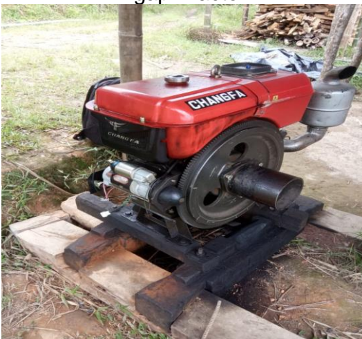
Figura 5. Motor utilizado en el proceso de extracción del jugo de caña.
