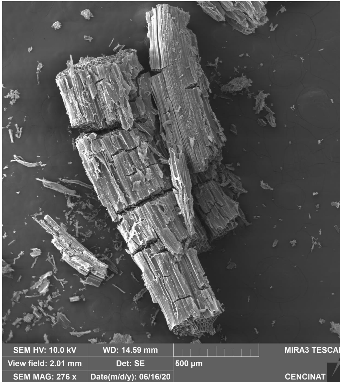
Figura 17. Análisis SEM (2) determinación del tamaño y forma de la partícula de ceniza resultante del proceso de combustión.
