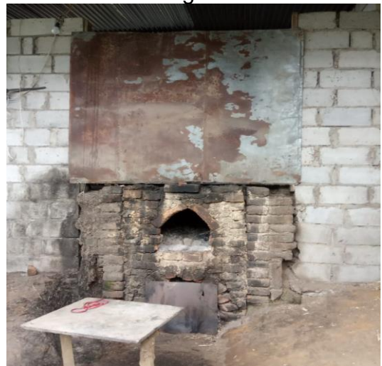
Figura 10. Horno para la combustión del bagazo.
