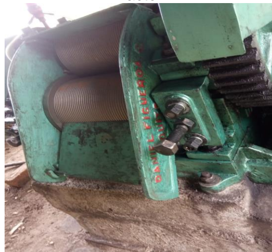
Figura 6. Trapiche utilizado para extraer el jugo de caña.
