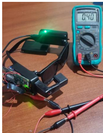
Figura 22. Medición del amperaje del dispositivo
