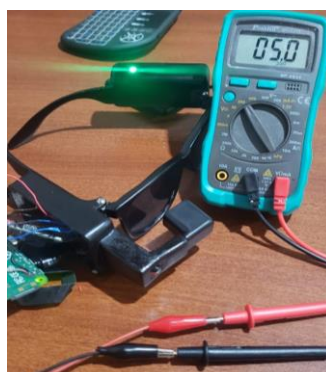
Figura 23. Medición del voltaje del dispositivo
