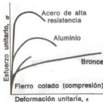
Figura 21. Deformación Unitaria del Aluminio vs Bronce y Acero (Groover, 1997)
