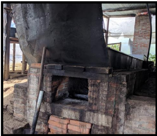
Figura 3. Infraestructura de los hornos para la elaboración de la panela.
