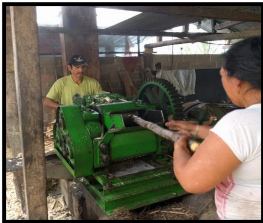
Figura 7. Proceso de la molienda de la caña de azúcar
