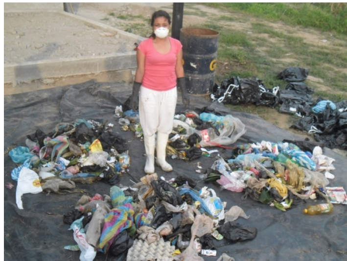
Figura 27. Muestra para el subproducto no menor a (50 kg)
