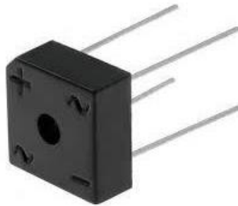
Figura 20. Puente Rectificador de Onda Completa
