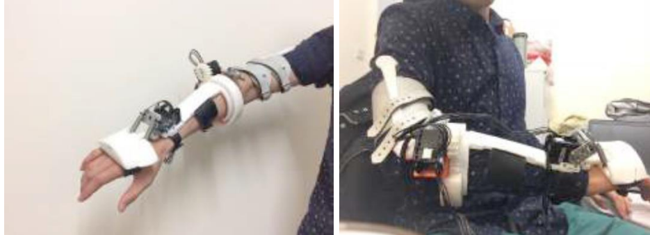
Figura 6- Exoesqueleto para supresión de temblores de la Imperial College of London (Huen, Liu, & Lo, 2016)
