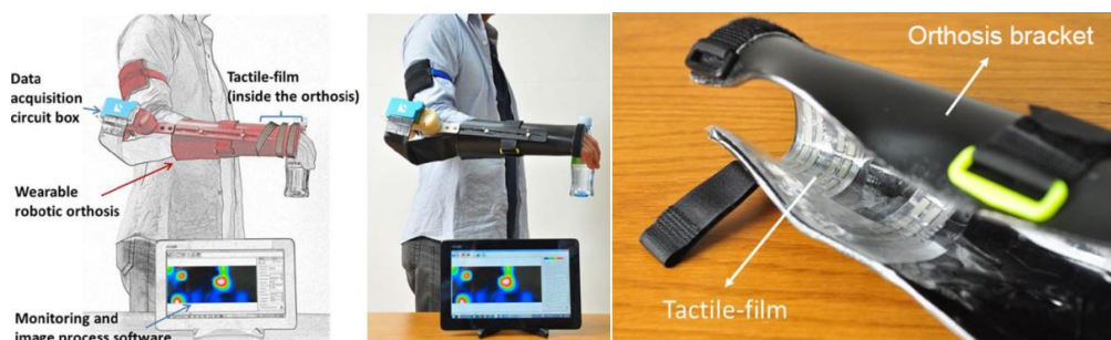
Figura 7.- Elementos principales del dispositivo robótico wearable. (ITRI, 2015)
