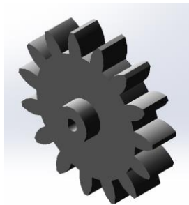
Figura 57.- Pieza 2-4, Piñón (engrane 1) para transmisión de potencia.
