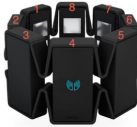
Figura 64.- Electrodo y su ubicación en el dispositivo MYO Armband. (Chrisgoodine, 2014)
