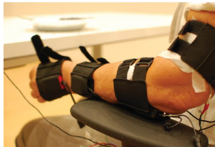
Figura 9.- Paciente con el prototipo de TREMOR Neurorobot. Nota: Paciente con sensores inerciales y electrodos de neuroestimulación. (Rocon E, 2012)
