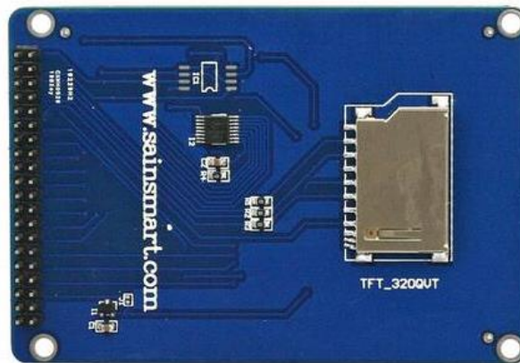
Figura 10. Vista posterior de pantalla TFT-touch 3.2" (SainSmart, 2018)
