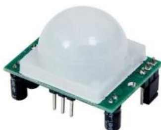
Figura 12. Sensor de movimiento PIR HC-SR501. (Adafruit Learning System, 2017)
