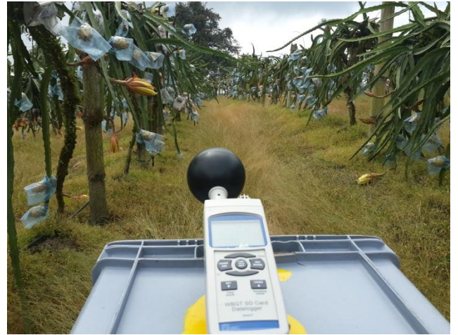
Toma de mediciones de WBGT en campo
