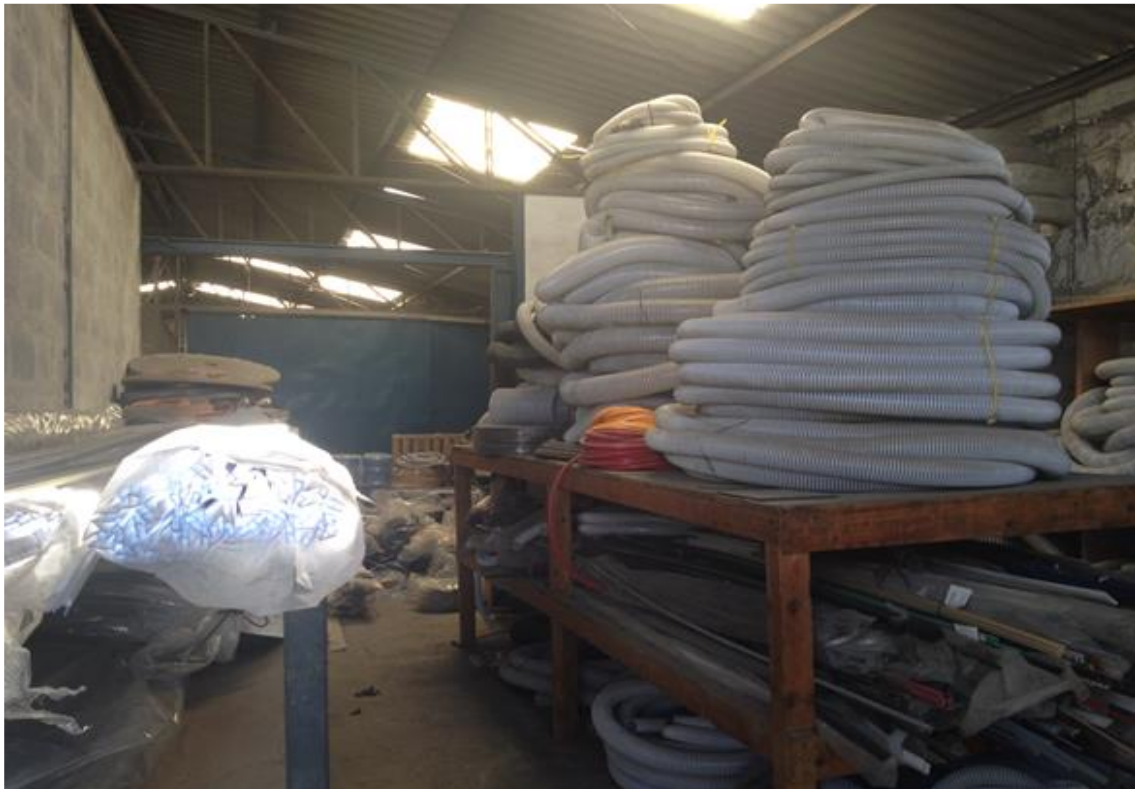
Imagen 9. Desplome por mal apilamiento
