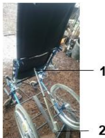
Figura 40. Actuador Lineal instalado en la silla para bipedestación
