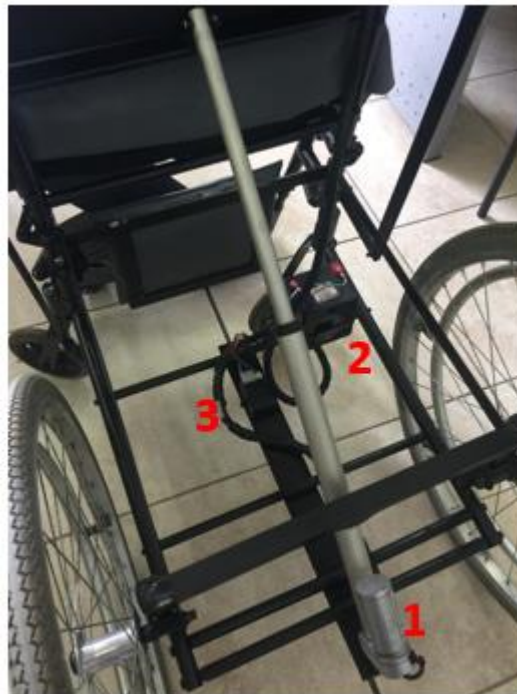
Figura 43. Cableado de la silla para bipedestación
