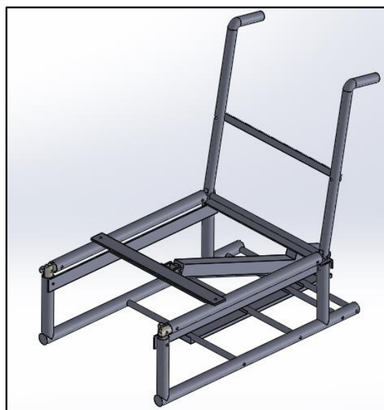
Figura 22. Estructura Principal de la Silla de Bipedestación
