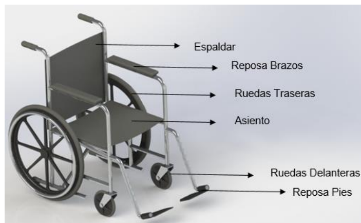
Figura 6 Partes de la Silla de Bipedestación
