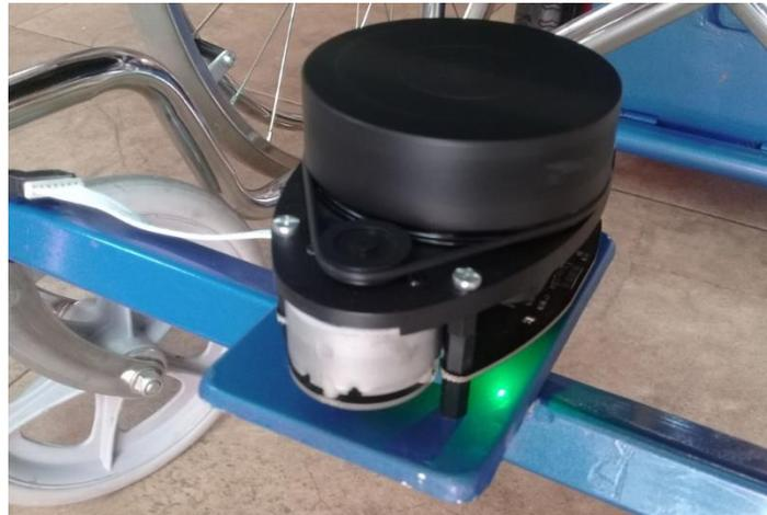
**Figura 40.** Ensamblaje del escáner láser.
