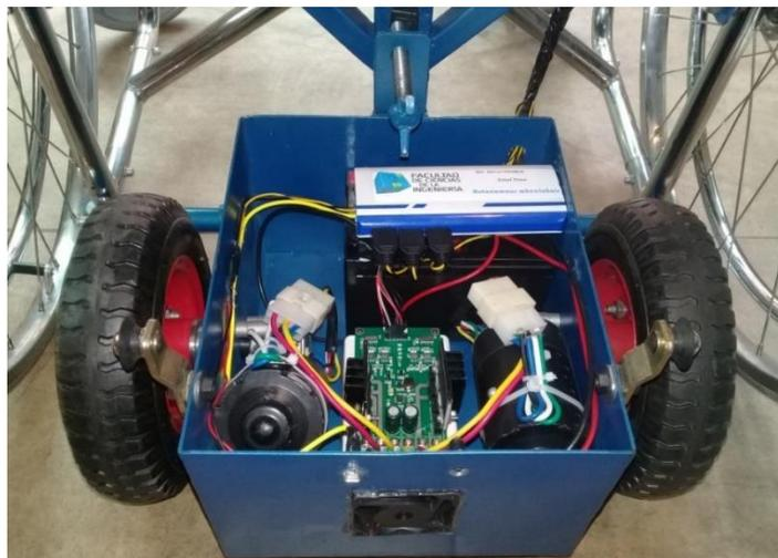
**Figura 41.** Ensamblaje del subsistema electrónico
