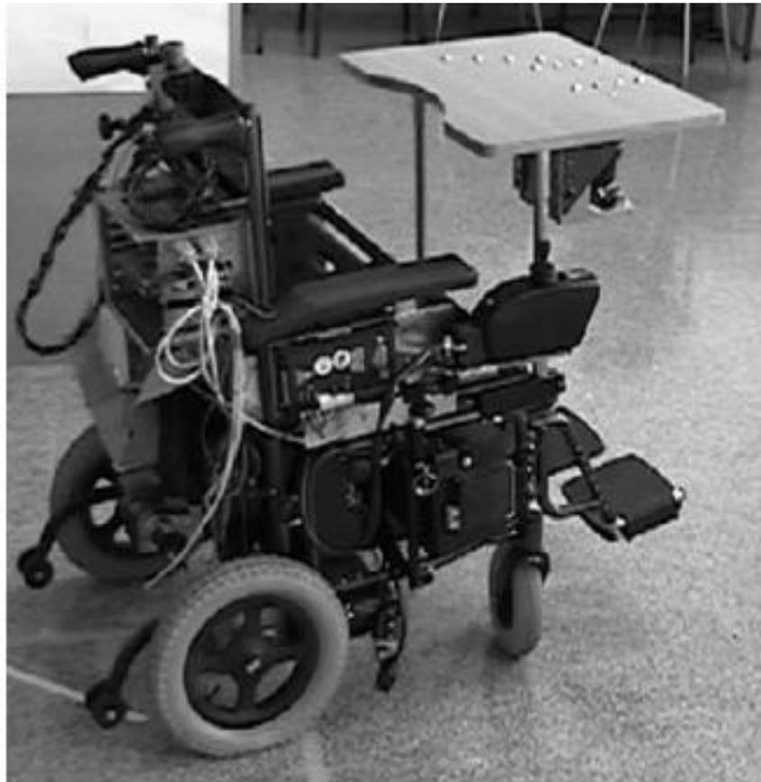
**Figura 2.** Silla robótica controlada por voz.
