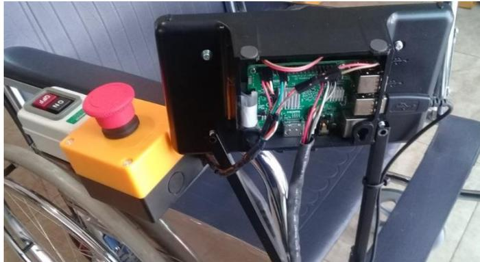
**Figura 39.** Ensamblaje de Raspberry Pi 3, pantalla táctil y pulsadores.
