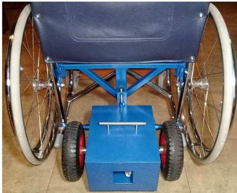
**Figura 38.** Ensamblaje del módulo mecánico acoplado al sistema base.
