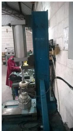
**Figura 23.** Soporte y cilindro para prensado.
