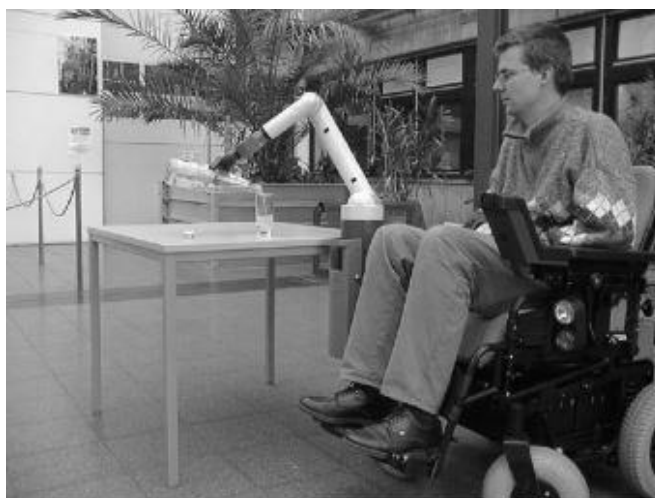
Figura 6. Robot “MANUS” (robot móvil montado sobre una silla de ruedas) (Barea, 2012)
