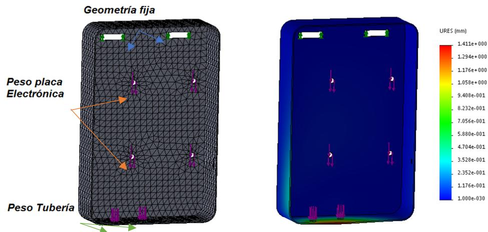
**Figura 10.** Análisis de elementos finitos de la carcasa
