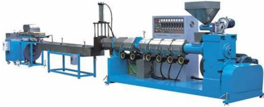
Figura 3. Recuperadora / peletizadora de PET Modelo VM-80 PET (AsianMachinery, 2007)
