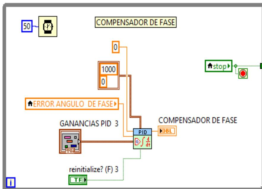
Figura 47. Esquema de control de compensación de fase
