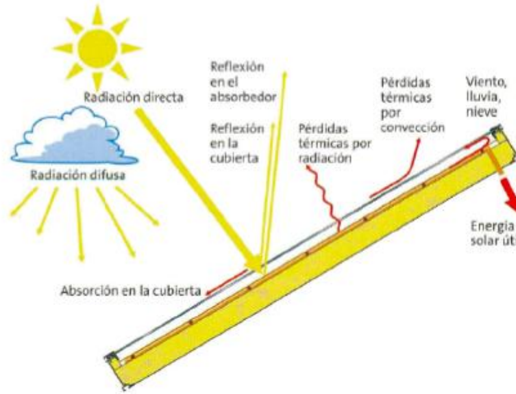
Figura 23. Diagrama de pérdidas en un colector solar plano (Vasquez, 2003)
