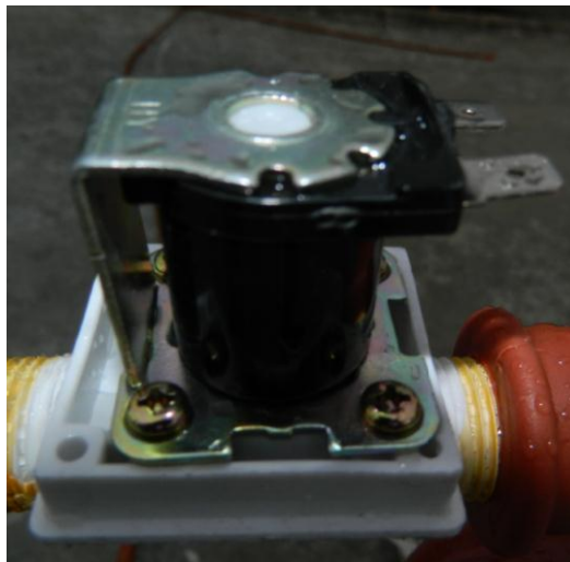
Figura 26. Electroválvulas de riego utilizada en el prototipo
