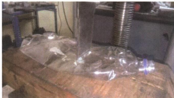
Fotografía 2. Montaje del envase plástico en la máquina universal de ensayos para ensayo de corte.
