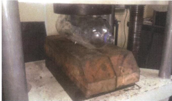
Fotografía 1. Montaje del envase plástico en la máquina universal de ensayos para ensayo de compresión.
