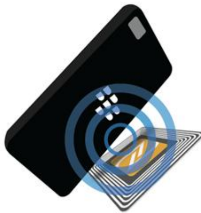
Figura 3. Modo de Funcionamiento Pasivo
