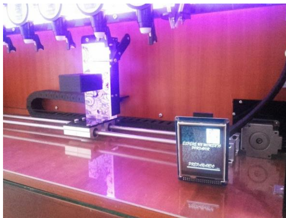
Figura 90. Manejo de actuadores por medio de Interfaz gráfica
