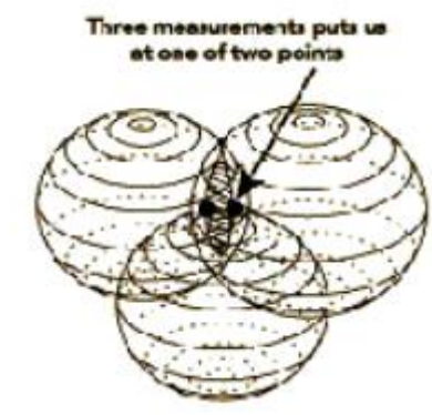
Figura 18. Esquema de triangulación (Gutovnik, 1999)
