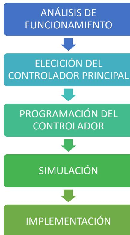
**Figura 3.5** Proceso del diseño del sistema de control.
