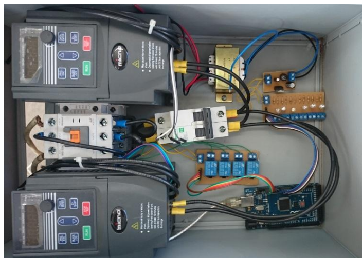
Figura 3.43. Subsistema eléctrico completo.
