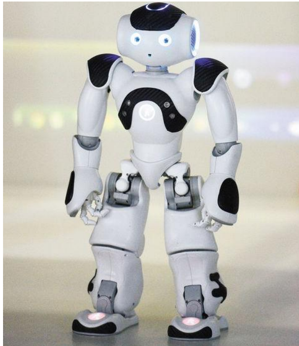
Figura 2.21. Robot tipo androide NAO.
