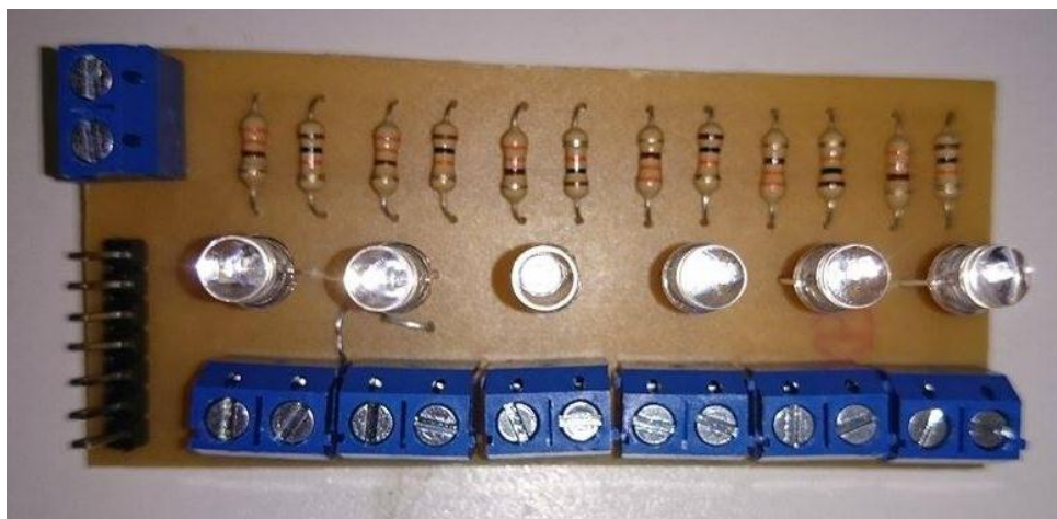
Figura 3.44. Placa de entradas de control.
