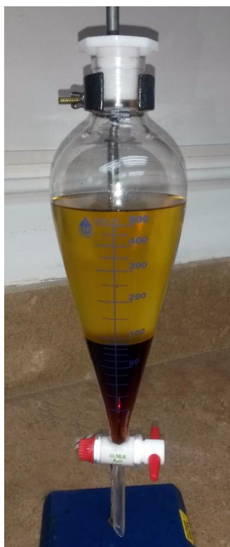
Figura 5. Separación del biodiesel y la glicerina
