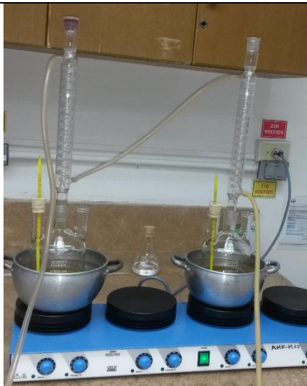
Equipo armado para la trasterificación
