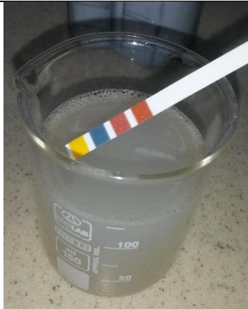
Medición de pH del agua de lavado
