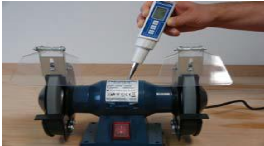
Vibrómetro VT 2700 comprobando una máquina
