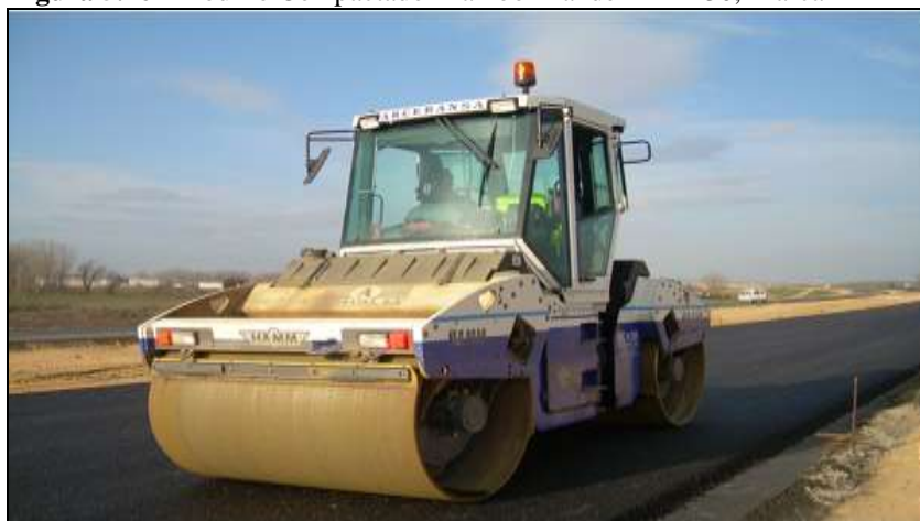
Figura 5.16 – Rodillo Compactador Tambor Tandem HD130, Marca HAMM.
