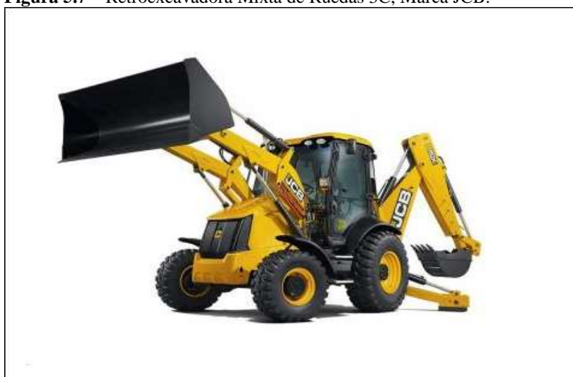
Figura 5.7 – Retroexcavadora Mixta de Ruedas 3C, Marca JCB.
