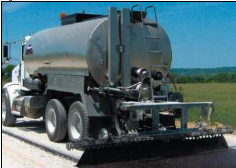
Figura 5.13 – Distribuidor de Asfalto SHOTTER II, Marca ETNYRE.
