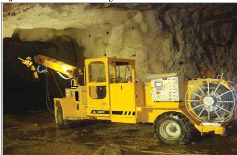
Figura 5.20 – Lanzador de Hormigón SPM407P, Marca PUTZMEISTER.
