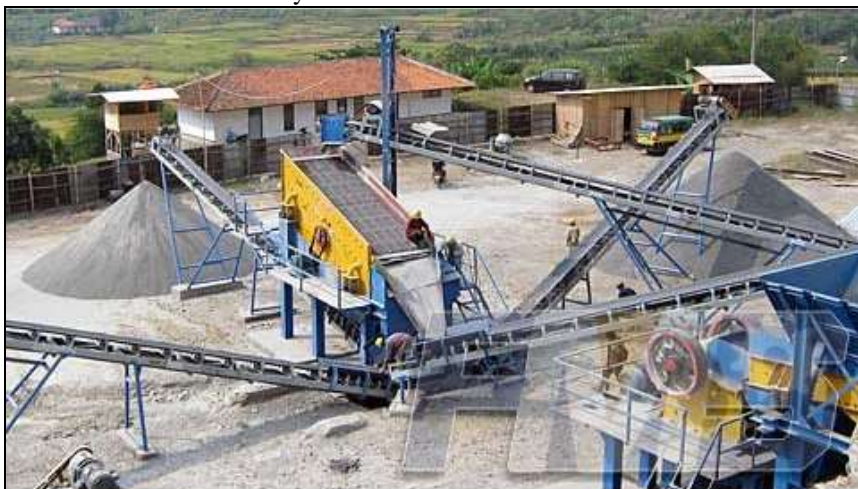
Figura 5.1 – Planta de Trituración de Agregados para la Construcción Marca TRIO/METSO/CEC – Proyecto Cuenca Molleturo
