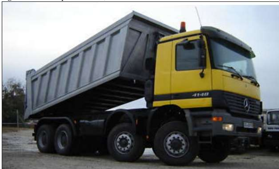
Figura 5.22 – Volquetas 4148k, Marca MERCEDES BENZ.
