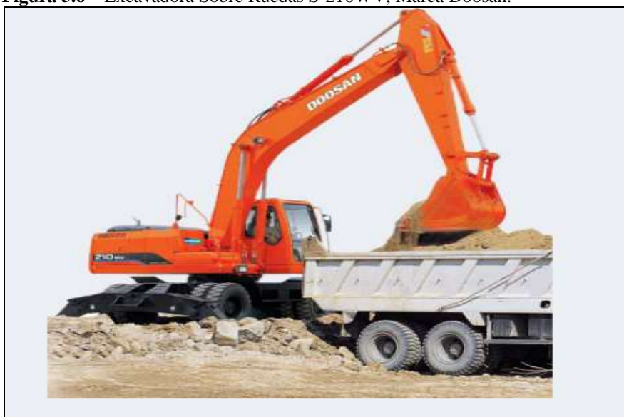
Figura 5.6 – Excavadora Sobre Ruedas S-210WV, Marca Doosan.
