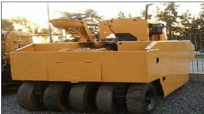
Figura 5.17 – Rodillo Neumático AP23, Marca MULLER.
