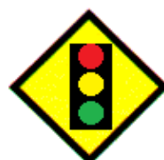
PROXIMIDAD DE SEMÁFORO
