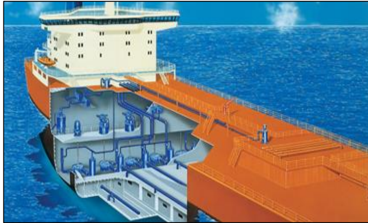
Figura 18. Cámara de Bombas de un Buque Tanque. Fuente: Ferrer S. (2010). Specialized training for oil tankers Ch5.
