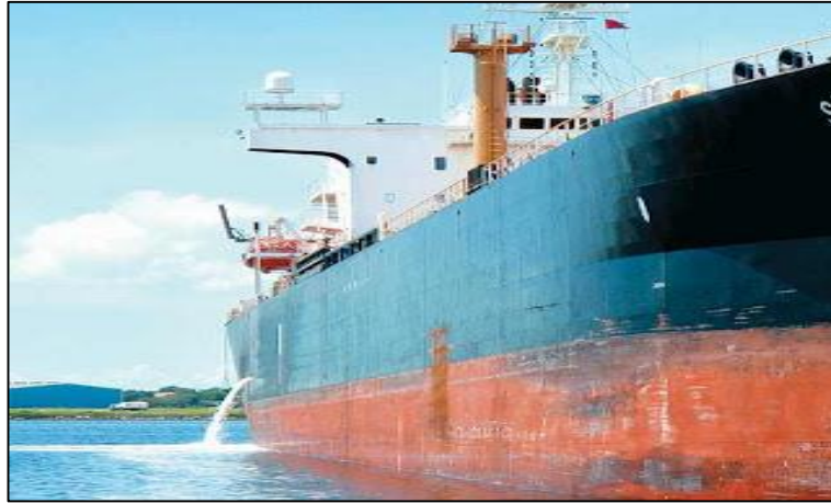
Figura 8. Operación de deslastrado sobre línea de flotación. Fuente: Ferrer S. (2010). Specialized training for oil tankers Ch5.
