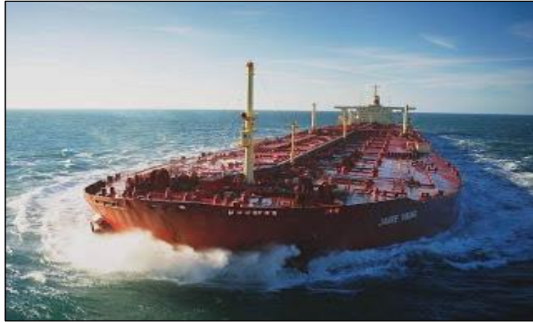
Figura 10. Entramado de tubos sobre la cubierta de un Buque Tanque. Fuente: Ferrer S. (2010). Specialized training for oil tankers Ch5.
