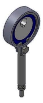
Figura 56. Diseño del mecanismo del punzón superior
