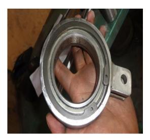
Figura 94. Anillo 6914, acoplado con rodamiento y anillo de retención
