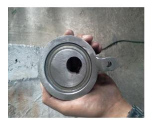
Figura 95. Anillo 6910, acoplado con rodamiento y excéntrica
