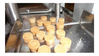
Figura 122. Pastillas producidas por el sistema de Compresión
