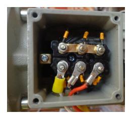
Figura 38. Conexión triangulo del motor seleccionado
