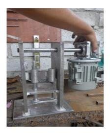
Figura 104. Acople del motor
