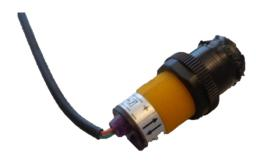
Figura 45. Sensor digital capacitivo
