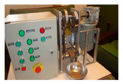
Figura 116. Sistema de compresión de caramelos tipo pastilla
