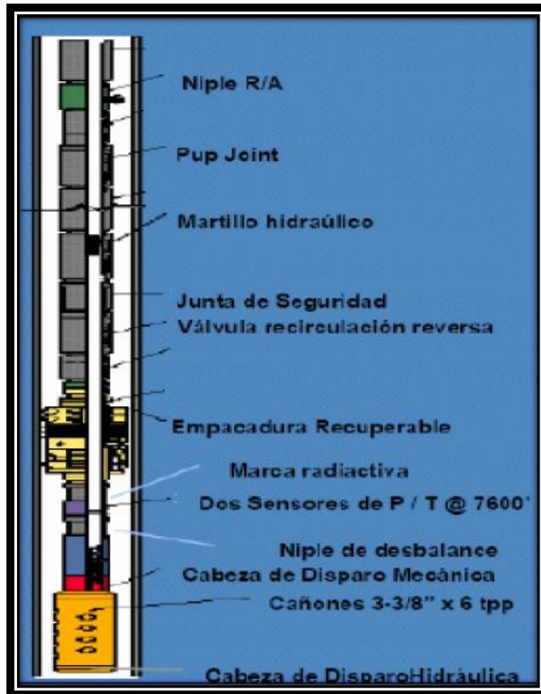
Figura 3.3 Partes de la Herramienta de cañoneo TCP (Baker Hughes, 1997)
