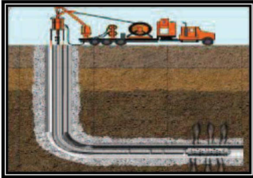
Figura 2.4 Sistema de cañoneo Coiled Tubing
