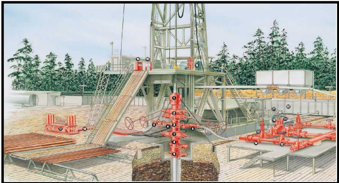
Figura 1. Ubicación del equipo de Preventor de Reventones en el taladro
